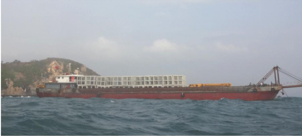
图 2.4-6 工程船装载运输礁体
