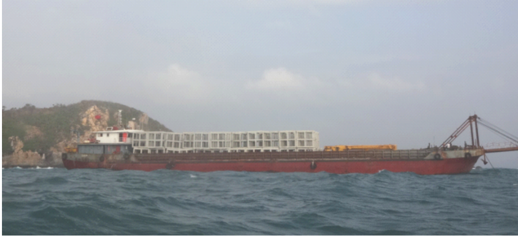
图 2.4-6 工程船装载运输礁体
