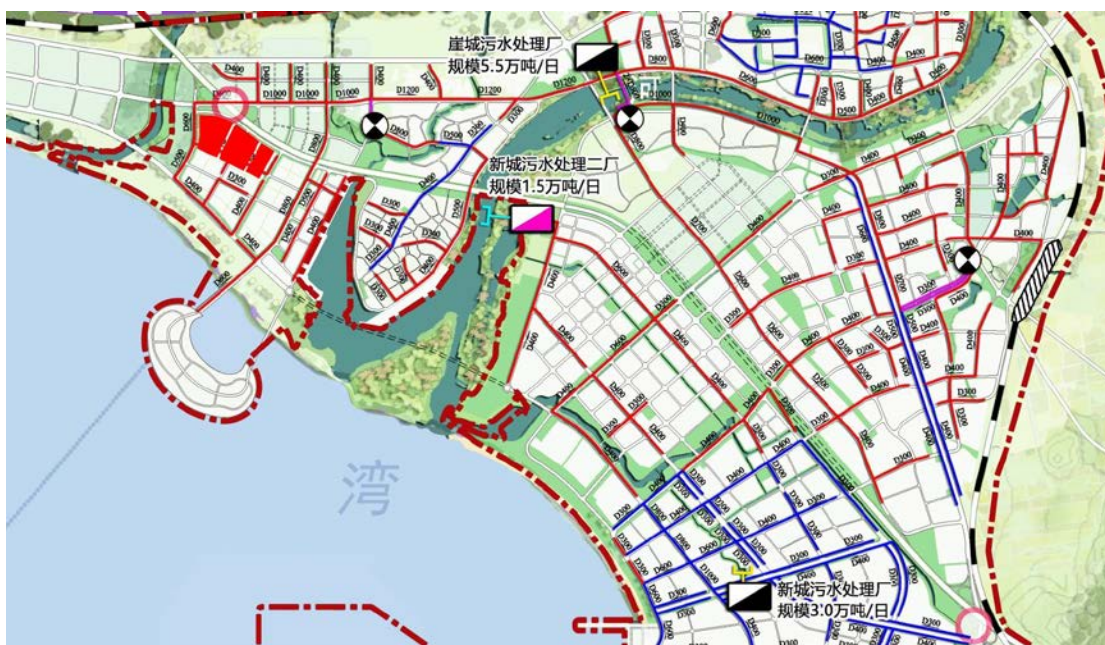
图 4-13 三亚崖州湾科技城果蔬批发市场污水工程规划图
