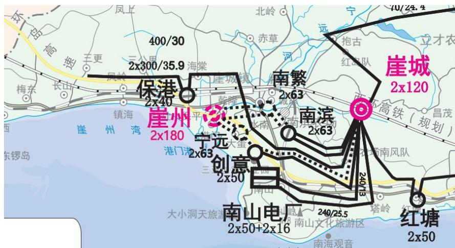
图9 高压电网接线图
