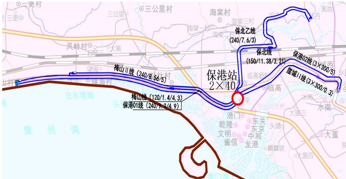
图 10 中压配电网接线图
