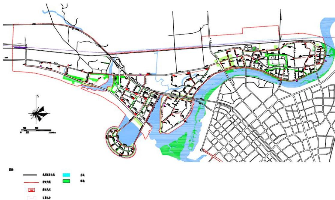
图 13 主干光节点及联络光缆规划图
