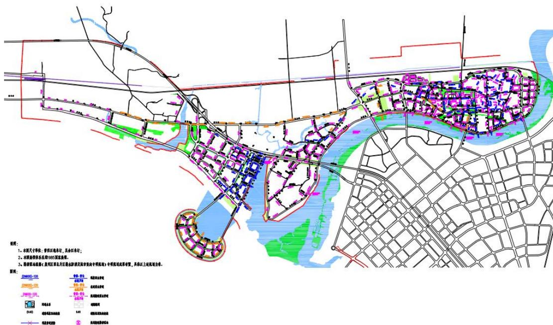
图 5 雨水系统规划图
