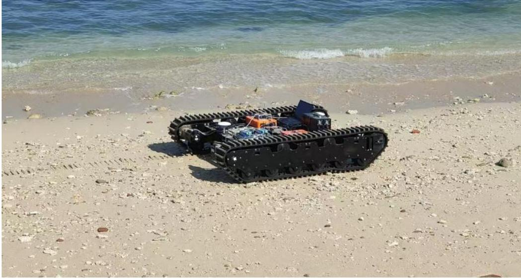
图 1.5-13 深海着陆车履带底盘测试实验照片
