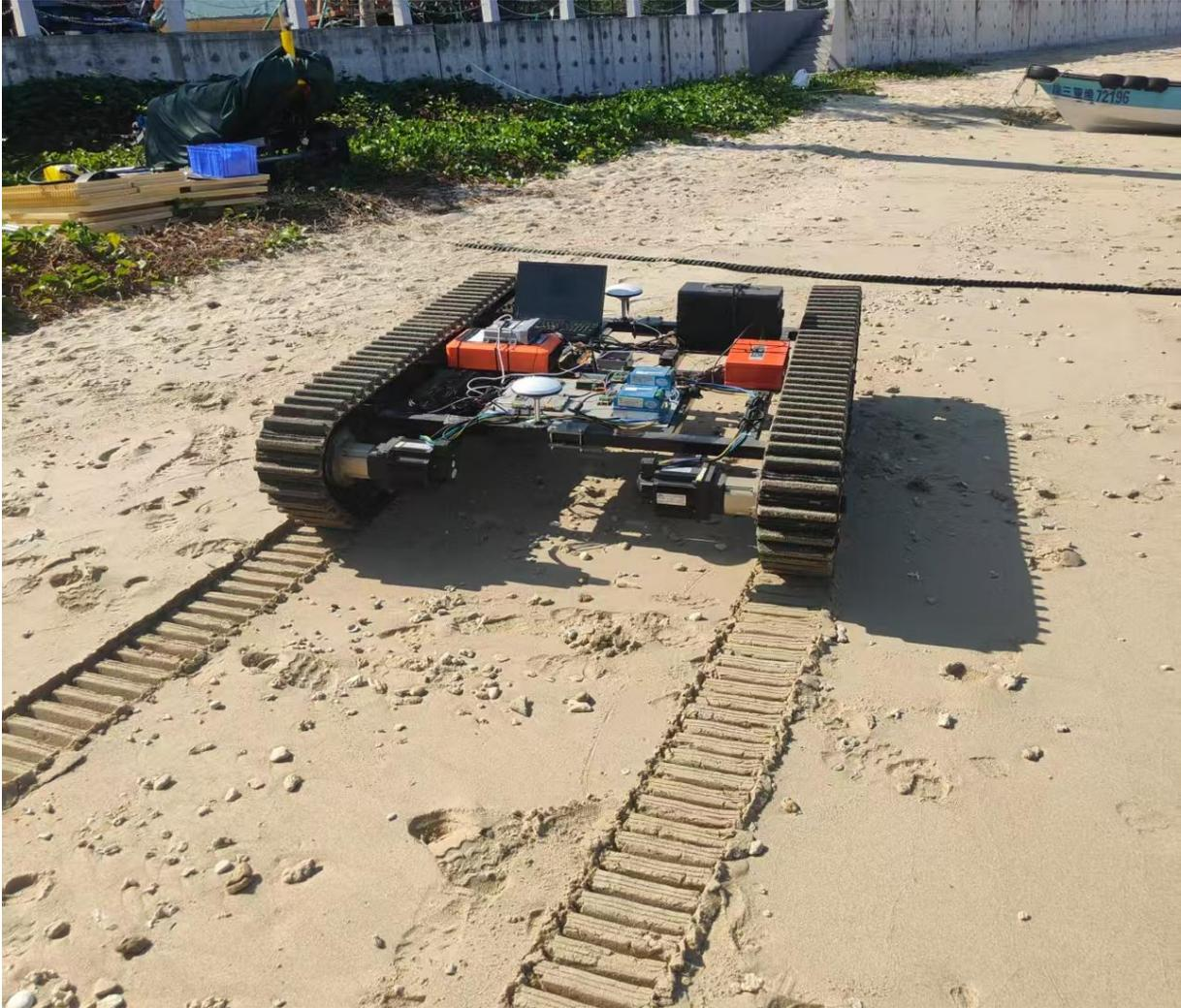
图 6.4-1 深海着陆车履带底盘以往实验情况
