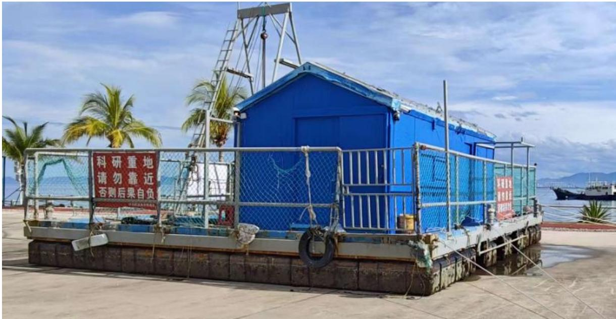
图 1.5-4 海上试验浮台实物图
