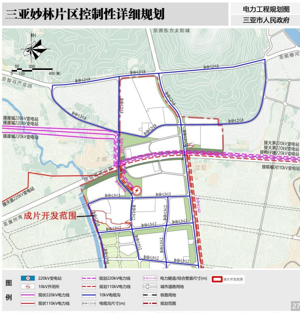
图 2-11 三亚妙林片区电力工程规划图
