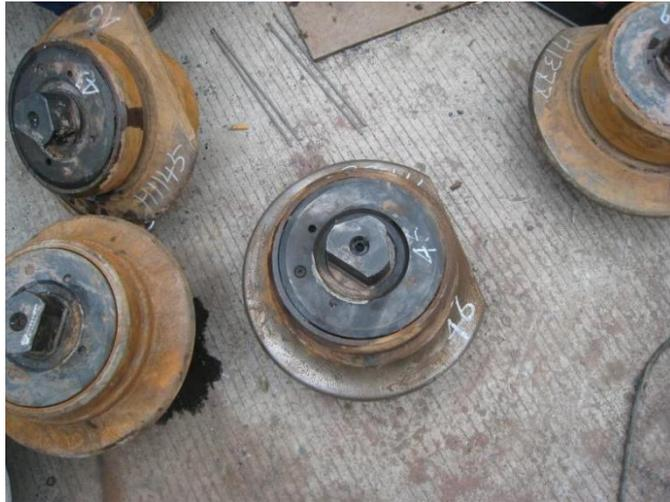
图 7.1-1 大直径复核泥水加压平衡盾构更换下来的刀具
