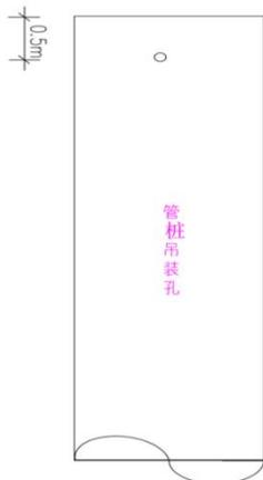
图 2.3.2-2 吊装孔示意图
