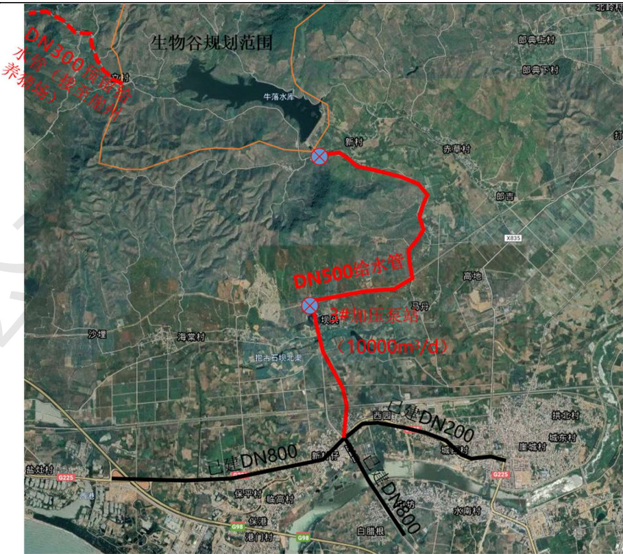
图 5-1 生物谷规划区外接入段给水干管布置图
